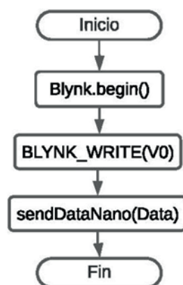
Figura 11. Diagrama de flujo para monitoreo de cambios en variables virtuales
